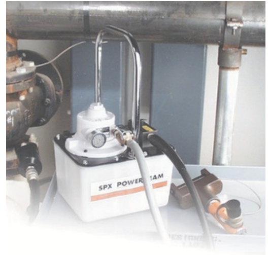
PA17-Pumpe im Einsatz mit einem Flanschspeizer.
