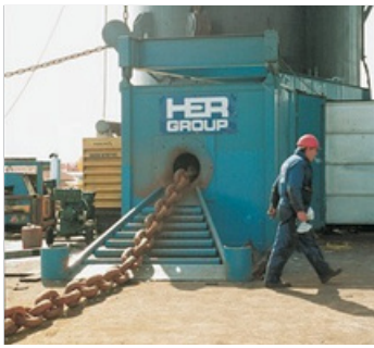
Eine PE4004S-Pumpe und ein RD3006-Zylinder beim Einsatz in einer Spezialpresse zur Reparatur defekter Kettenglieder in der Schiffsbauindustrie.
